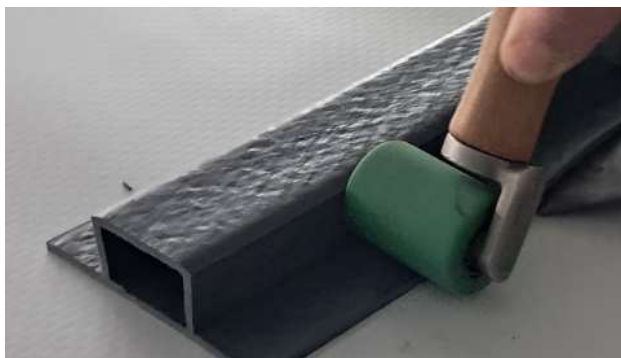
Obr. 3: Provedení spoje z obou stran zkušebního profilu
