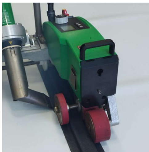
Obr. 10: Detail svařování automatem
