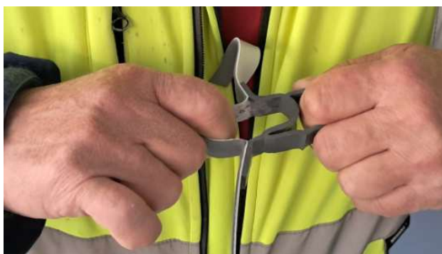
Obr. 5: Zkouška odtržení profilu na zkušebním tělese
