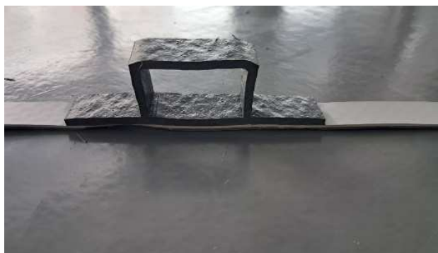
Obr. 4: Nařezání zkušebních těles pro zkoušku spoje
