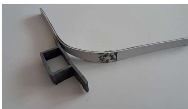
Obr. 6: Roztržený svar – příklad poškození v profilu
