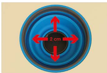
11. Vyjmout stavební ochrannou zátku, vnitřní Flex-lamela umožní vycentrování až do 4cm (+/- 2cm ze středu) v tělese odtoku
