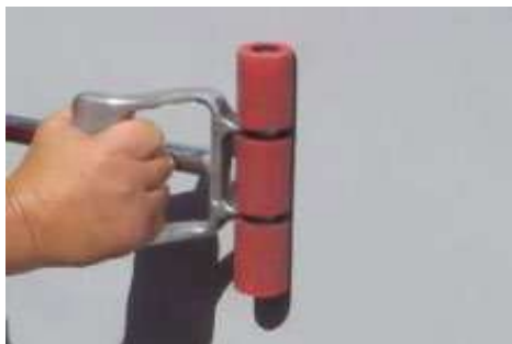
Stlačení lepených ploch ručním válečkem
