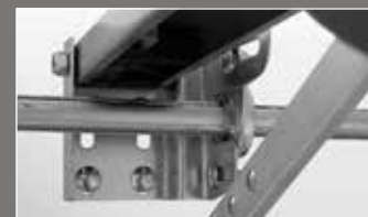
sřředová konzola uchycení pohonu a hřídele
